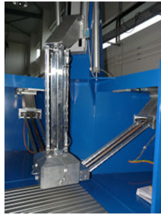
Robot Orthoglide 3 axes et 5 axes (brevets)
