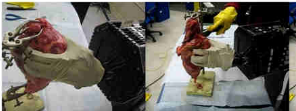
(a) 变胞机械手与Fanuc机械臂相结合进行生产
